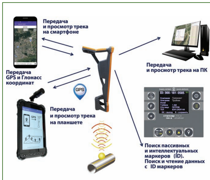
Рис. 7 Передача данных с маркероискателя ПМ-3 на внешние устройства для просмотра
